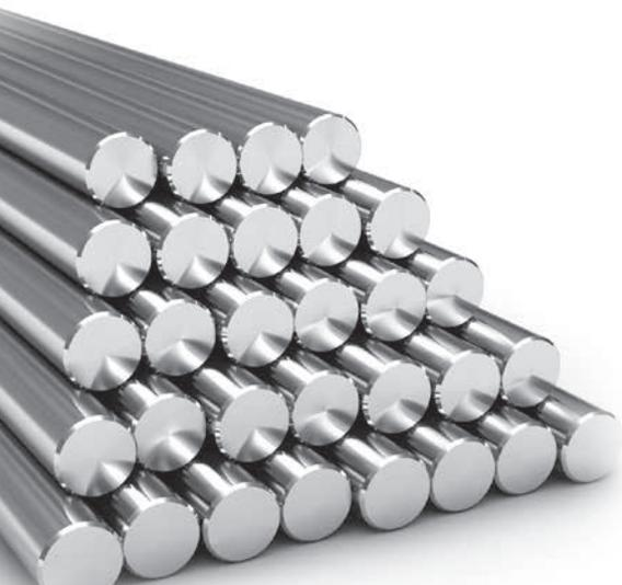
La **componentistica protesica** viene realizzata con la lega di **Titanio Grado 23, la versione a maggior purezza del Grado 5**, che garantisce oltre ad una ottima biocompatibilità anche una elevata resistenza alla frattura che lo rende indicato per la fabbricazione di protesi.
